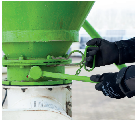
Afbeelding 2 14: Openen sluitklep
