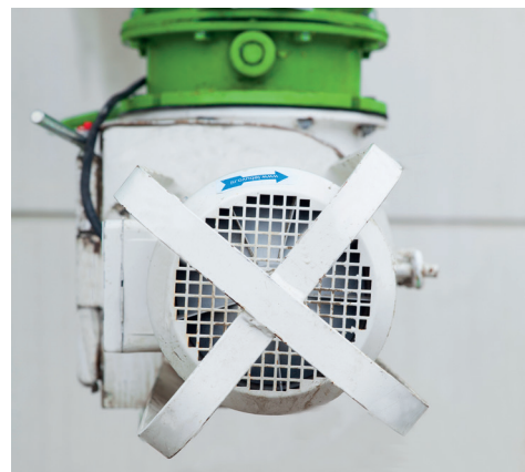
Afbeelding 2 12: Draairichting motor
