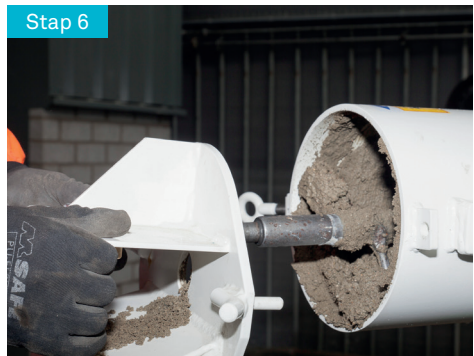
Afbeelding 2 21: Mantelkap verwijderen
