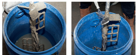
Afbeelding 2 26: Uitvijlen mortel
