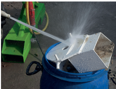
Afbeelding 2 27: Schoonspuiten mengkap
