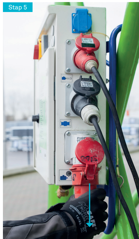
Afbeelding 2 20: Verwijderen netstroomkabel
