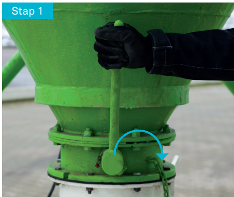
Afbeelding 2 17: Sluitklep bedienen
