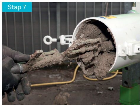
Afbeelding 2 22: Mengworm verwijderen
