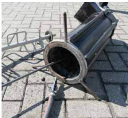
Afbeelding 2 18: Schoonmaken mantelbuis en mengas
