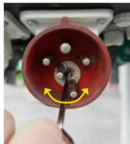
Afbeelding 2 15: Draairichting corrigeren
